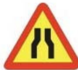
TP-17 ESTRECHAMIENTO DE CALZADA
