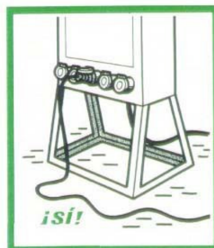
Hay que proteger al máximo las canalizaciones eléctricas contra los riesgos de aplastamiento, cizalladura, cortes, etc.... Debe remplazarse todo cable estropeado..
